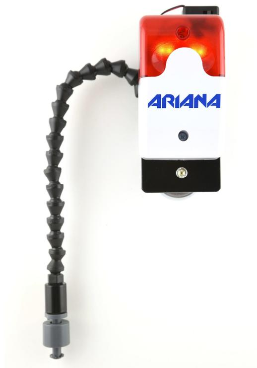
**ARIANA-Überlaufschutz-Sirene** ist ein wichtiges Instrument für jede Bearbeitungsmaschine, die mit Emulsion oder mit Öl befüllt wird. Die Überlaufschutz-Sirene meldet akustisch und per Lichtsignal ein bevorstehendes Überlaufen. Durch Einstellung des beweglichen Gelenkschlauchs kann man das Niveau im Becken bestimmen. Ein Überlaufen wird durch die akustische Warnsirene signalisiert.
